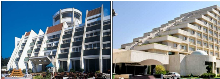
تصویر (۵): فرم مورب یا پلکانی جهت کنترل ریزش آوار (سازمان پدافند غیرعامل کشور، ۱۳۹۲)
